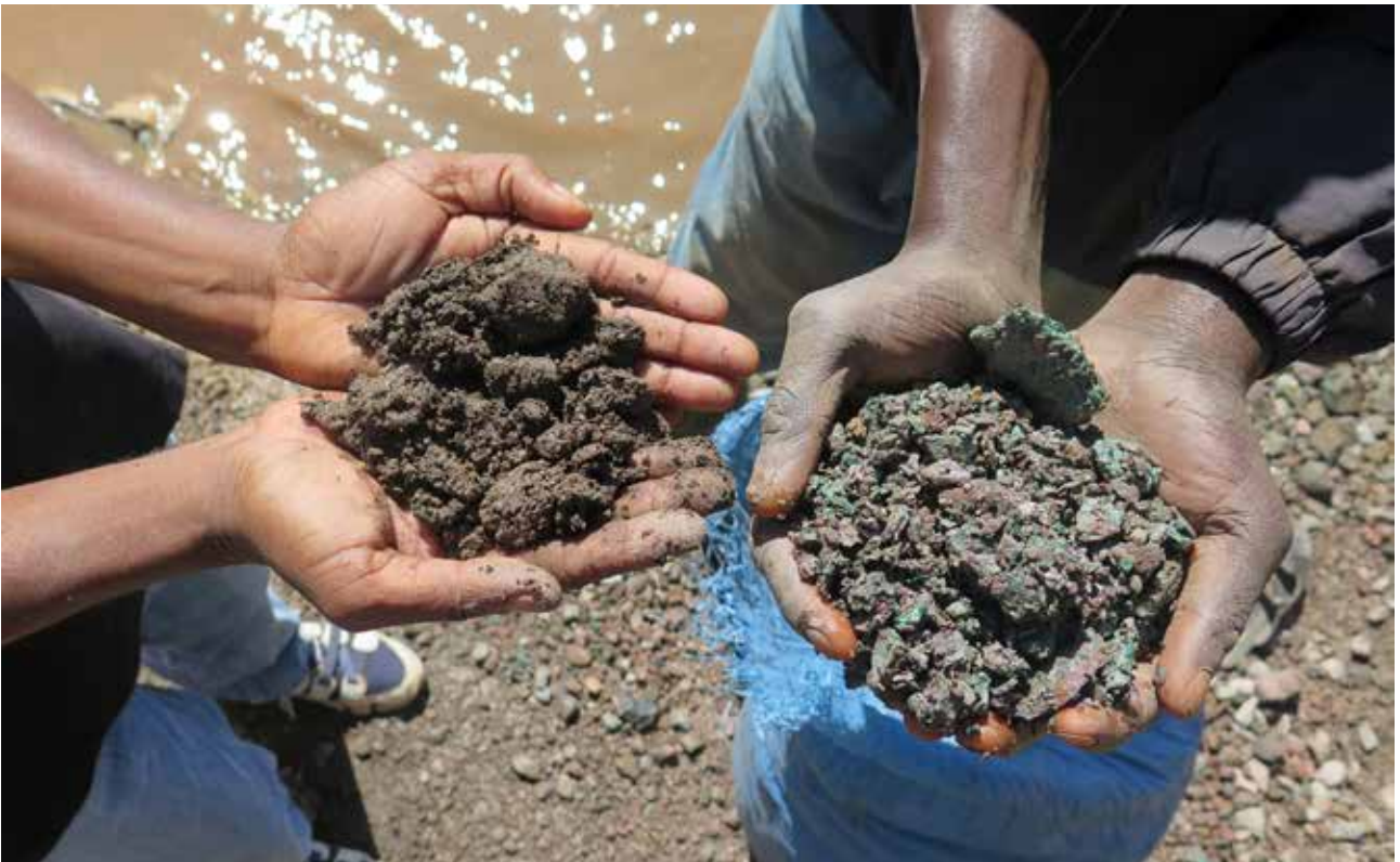
手工采矿者手捧他们在刚果(金)科卢韦齐郊外马洛湖附近仍在和已停止运营的工业化矿区尾矿堆中搜集到的钴矿石(左)和铜矿石(右)。采矿者之后必须拣选、清洗并打碎矿石，然后才出售给收购商行。2015年5月。© 国际特赦组织和非洲资源观察组织
