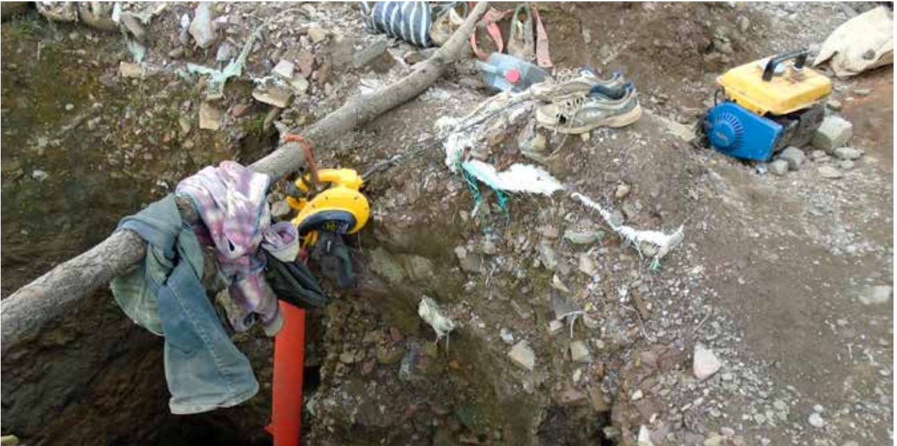
在刚果（金）科卢韦齐郊外的一座矿井，一个气泵为井下的手工采矿者输送氧气。一名采矿者告诉研究人员，当发电机用尽燃油时，他们就会无法呼吸，需要尽快爬出矿井。2015年5月。© 国际特赦组织和非洲资源观察组织
